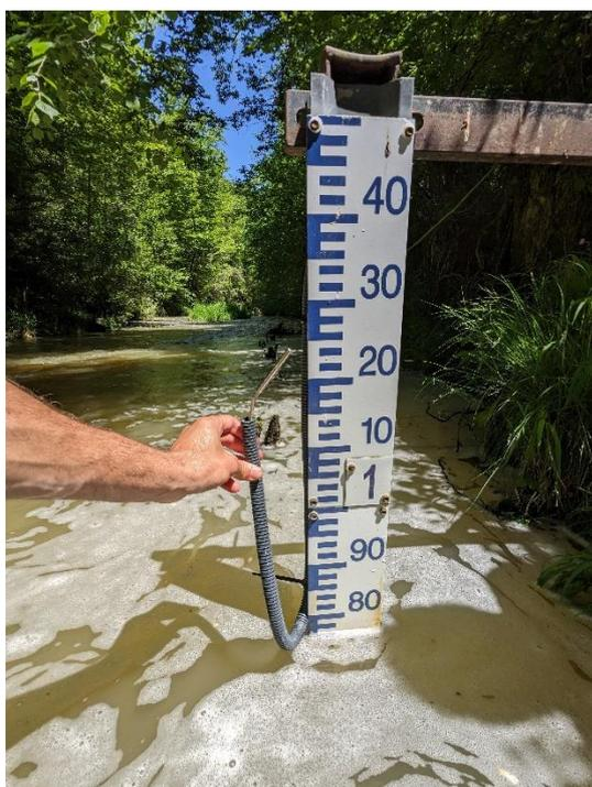
Figure 11. Installation de la sonde thermique au niveau de l'échelle limnimétrique de la station DREAL de Montberaud.
