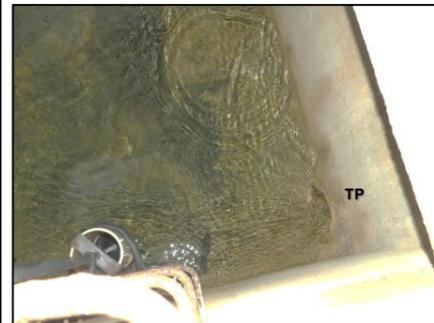
Conduite d'adduction et TP du captage A / Système de mesure des hauteurs d'eau
