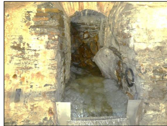
Vue du déversoir rectangulaire à lame mince installé sur la sortie du griffon 2 avec enregistrement des hauteurs d'eau
