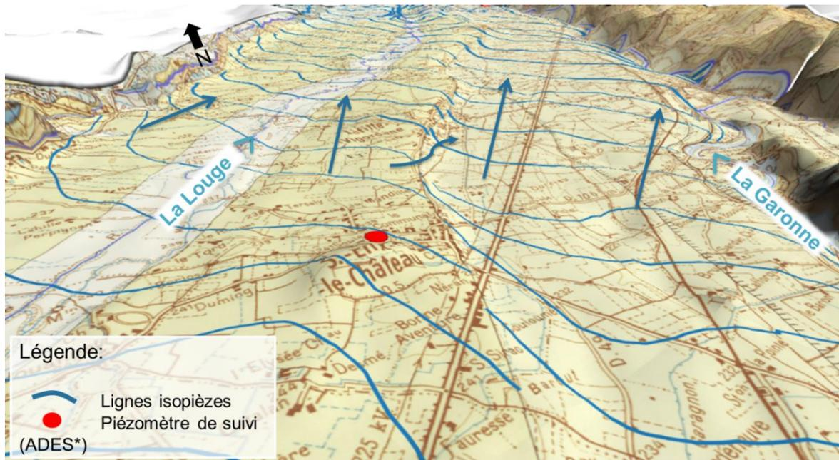
Figure 6 : Ecoulements des nappes alluviales de la Louge et de la Garonne au niveau de Saint-Elix-le-Château
