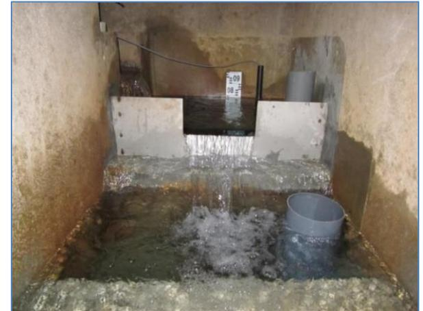
**Exemple Réseau Départemental de l'Ariège (09) - Déversoir rectangulaire à crête mince à contraction latérale installé sur la station de mesure de la source « Besole » (Esplas-de-Sérou)**
